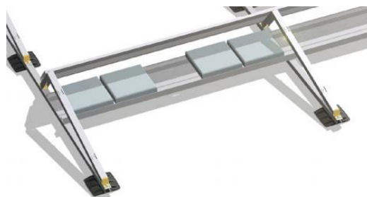
Figuur 4.3 – platdak frames eerste paneel zuid
