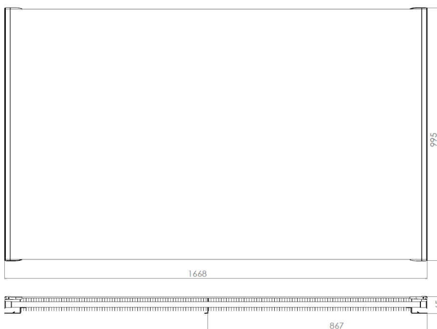
Figuur 3.1b - warmtepomppaneel type M2 285 200 landscape
